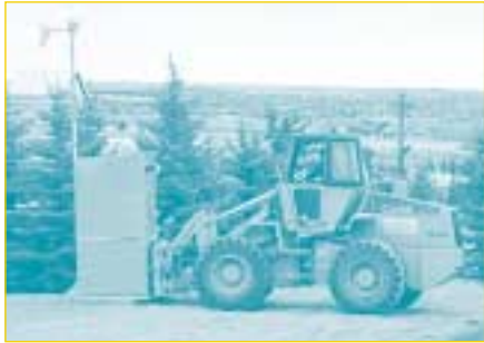
▲ Système éolien mobile, commandé à distance, Canada Olympic Park, Alberta. Tous les systèmes ne sont peut-être pas aussi mobiles, mais vous pouvez malgré tout emporter votre système si vous déménagez. (Photographie offerte gracieusement par Nor'wester Energy Systems Ltd.)
