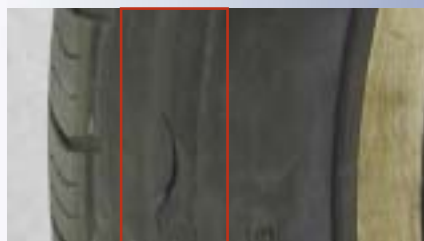
Il faut remplacer les pneus dont la semelle ou le flanc présente une coupure, une fissure ou une bosse.
