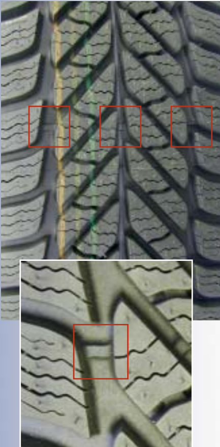
Le repère d'usure indique la profondeur minimale que les rainures du pneu doivent conserver.
