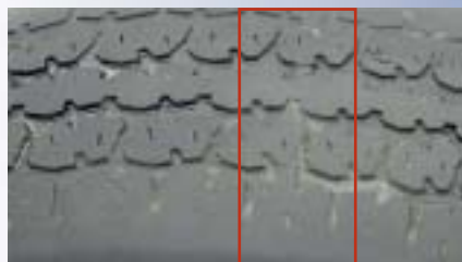
Il faut remplacer tout pneu dont le relief est usé jusqu'au repère d'usure de la semelle.
