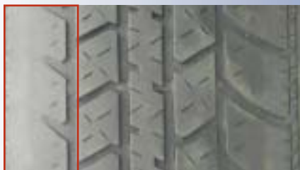
L'usure inégale des pneus peut être causée par un « mauvais alignement » des roues ou un « débalancement » des pneus.
