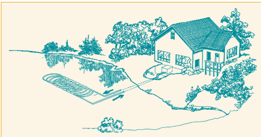
Les boucles de lac ou d'étang peuvent être utilisées aussi bien pour réchauffer que pour rafraîchir.
