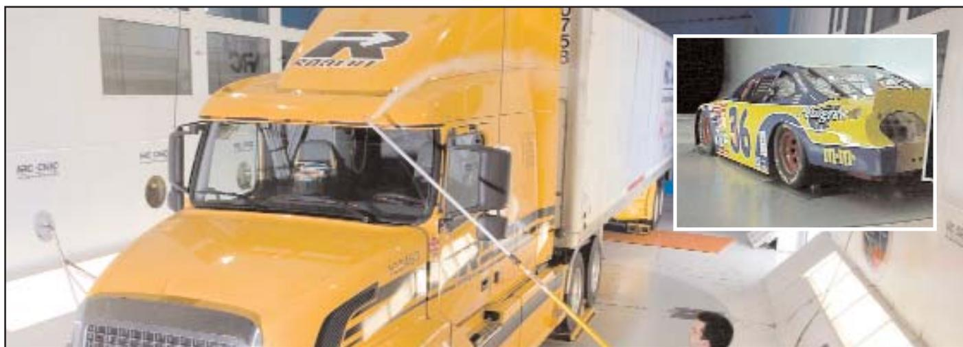
Des souffleries mettent à l'essai l'aérodynamisme de diverses formes de véhicules, d'immeubles et d'autres sujets. Ci-dessus, un camion de transport et une voiture de course sont mis à l'essai au Conseil national de recherches du Canada.
