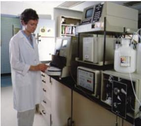
Système de chromatographie utilisé pour caractériser les glucides et les protéines de l'orge
