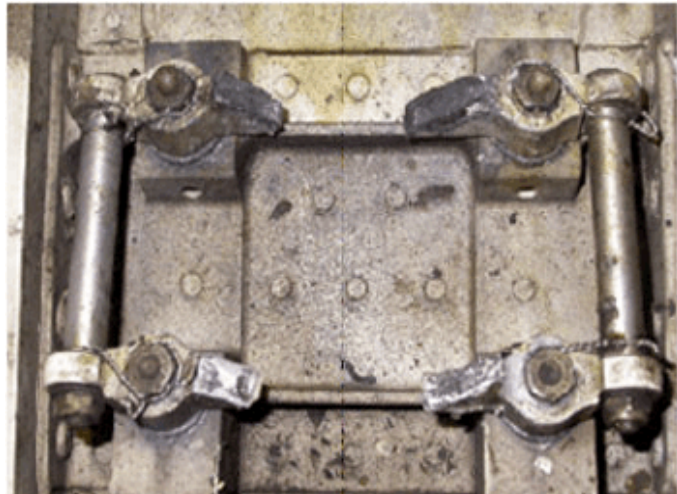
Photo 2. Ferrures de fixation supérieure et inférieure sur la cloison arrière
