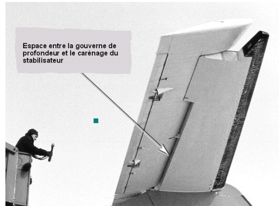
Photo 2. Vue de dessous du stabilisateur montrant l'espace et la gouverne de profondeur en position verrouillée
