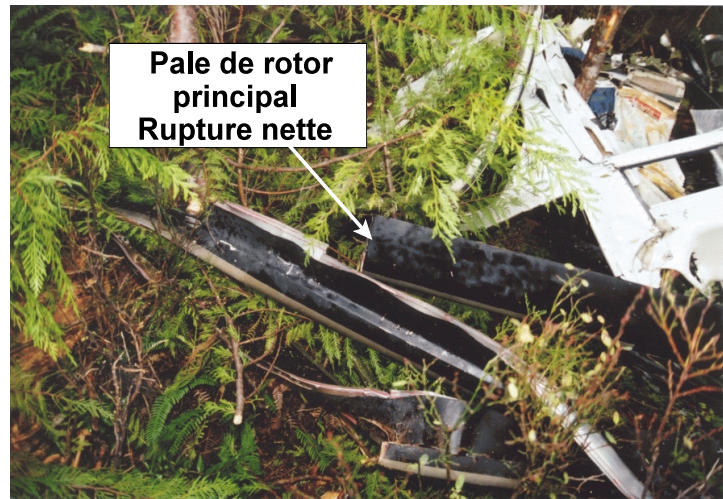
Figure 1 - Vue de la pale qui a subi une rupture nette
