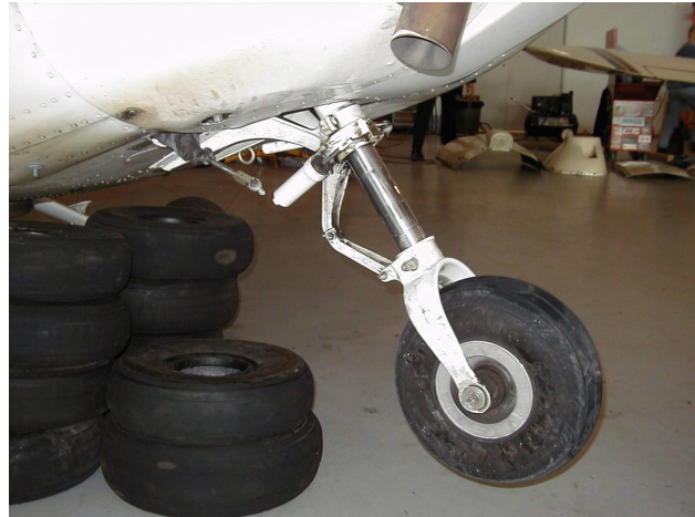
Figure 1 - Train avant endommagé du Cessna 172
