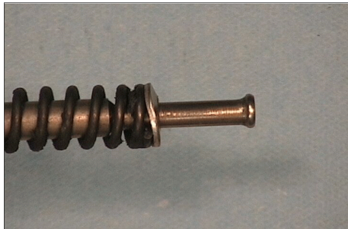
Figure 1. Ressort avec sa rondelle de retenue tordue sur la tige d'un des tubes de droite servant à l'orientation du train avant
