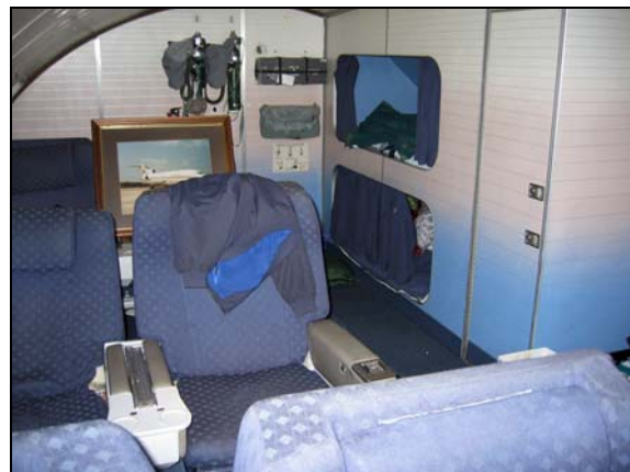
Photo 8. Poste de repos de l'équipage au niveau du pont supérieur
