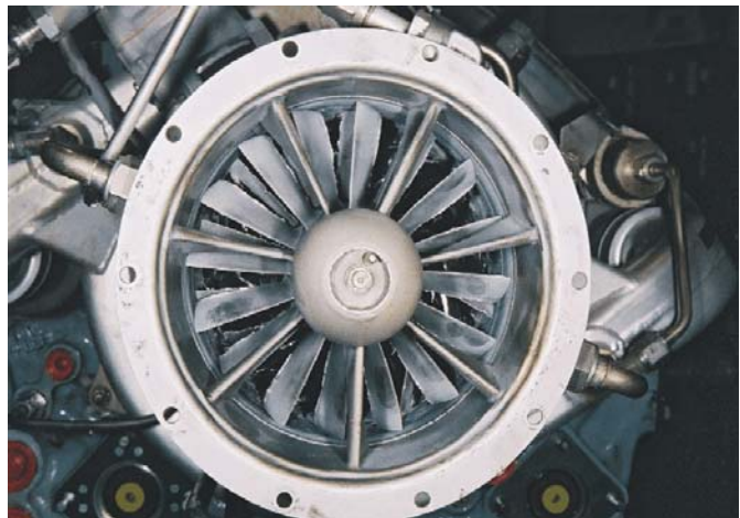
Photo 2. Aubage directeur d'entrée avant et bord d'attaque d'aubes mobiles du premier étage montrant des dommages minimes causés par des corps étrangers.
