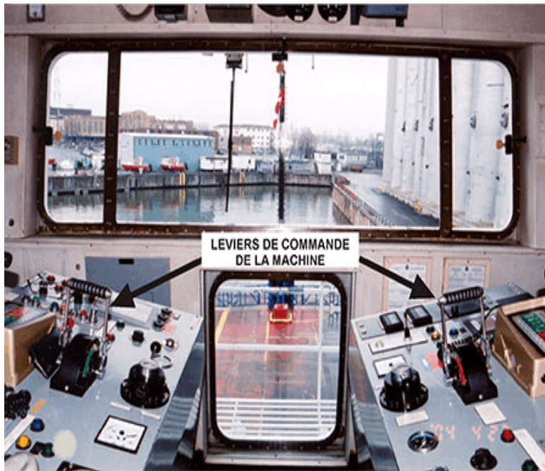
Photo 2. Postes de navigation sur la passerelle, vue avant ou arrière
