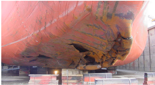
Figure 7. Avaries au coqueron avant
