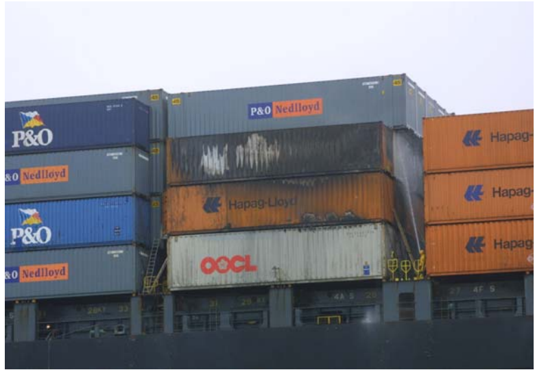
Photo 3. Conteneurs endommagés par le feu
