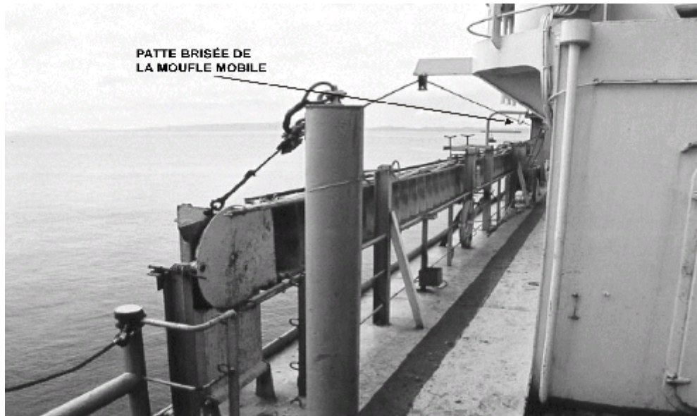
Figure 2 - Emplacement de la platine à oeil brisée et de la moufle mobile.
