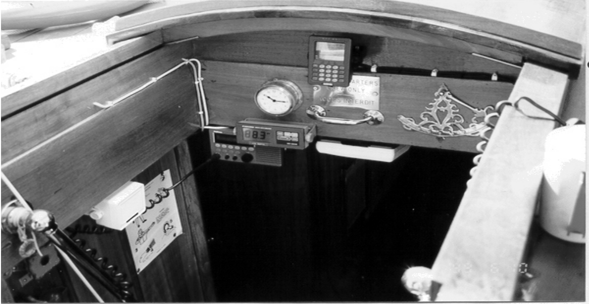
Indicateur de l'échosondeur (sous l'horloge), avec des instructions disant d'ajouter 10 (pieds). Sondages indiqués en pieds.
