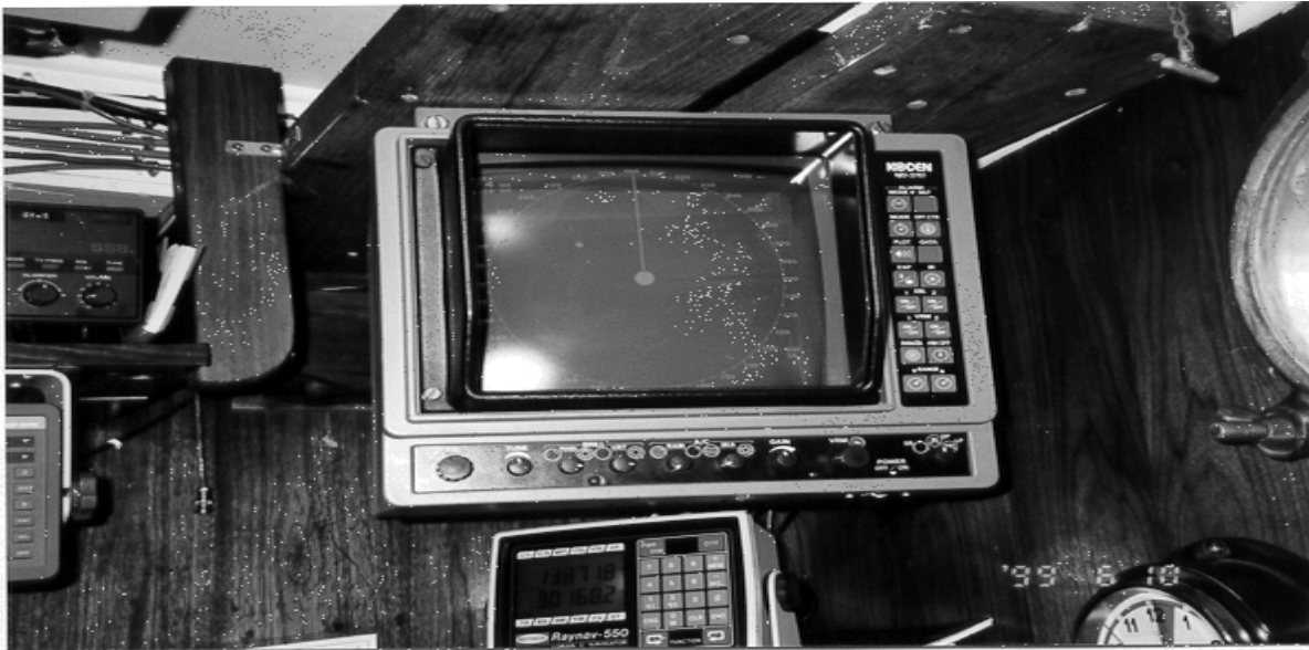
Affichage radar dans la salle des cartes—invisible du poste de commande de la manoeuvre.
