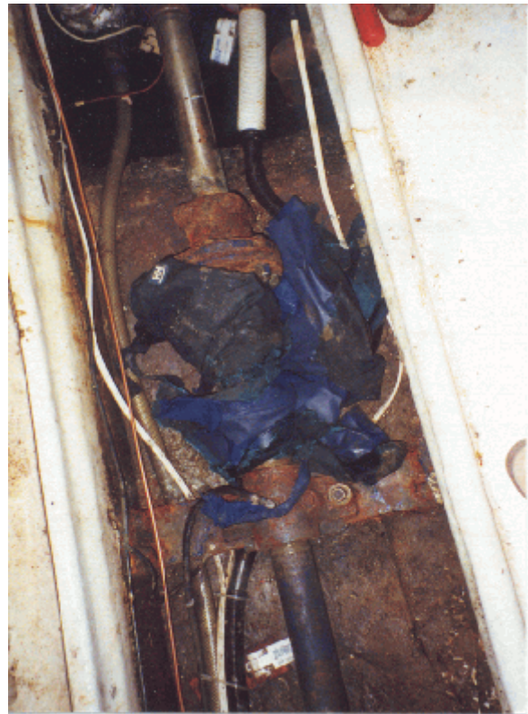
Photo 4. Morceaux du pantalon de pluie du propriétaire/patron pris dans l'accouplement d'arbre et l'arbre lui-même
