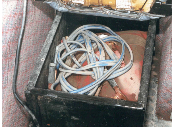
Photo 11. Câbles de démarrage trouvés par-dessus un gilet de sauvetage rangé sous un siège
