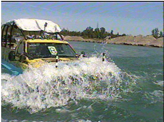
Photo 7. En eau perturbée à 8,3 km/h
