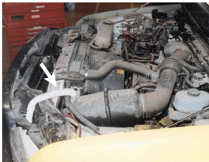
Photo 3. Tuyau de refoulement dans le compartiment moteur avant
