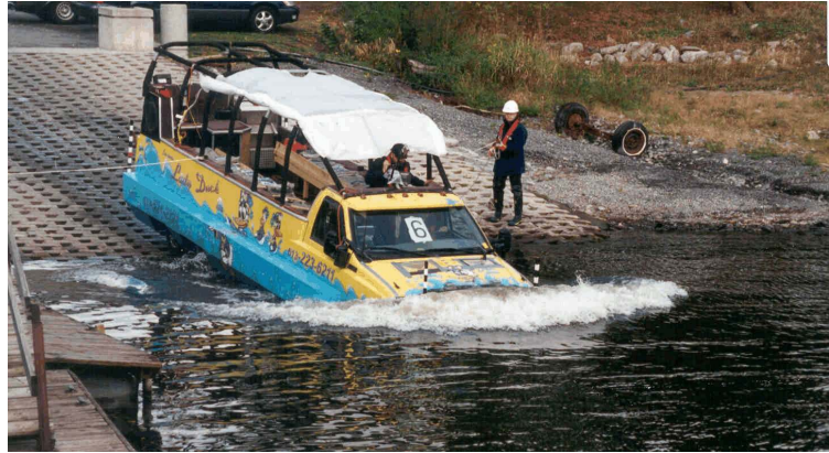
Photo 9. Mise à l'eau à 8 km/h avec la visière submergée d'environ 25 mm
