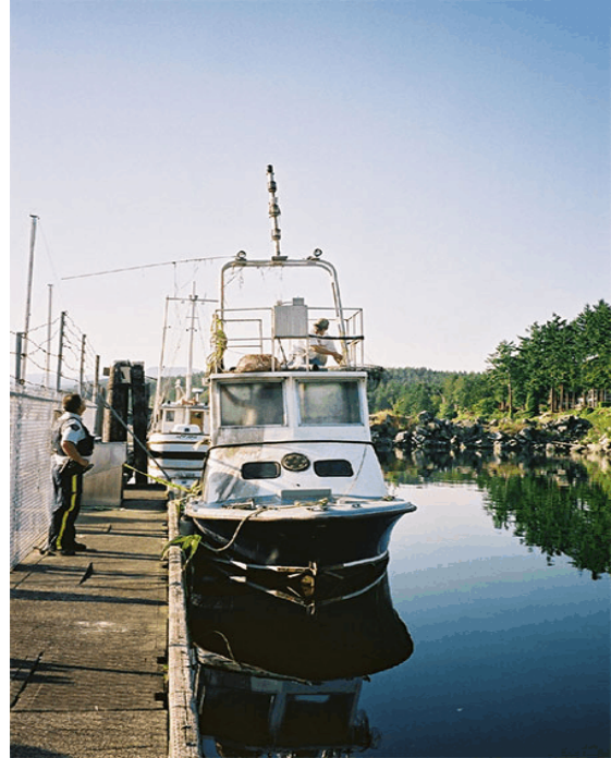
Photo 2. Le Bruce Brown en 2002. À noter la présence de la passerelle fermée, du poste de commande sur le toit de la passerelle et du mât en forme d'arche.
