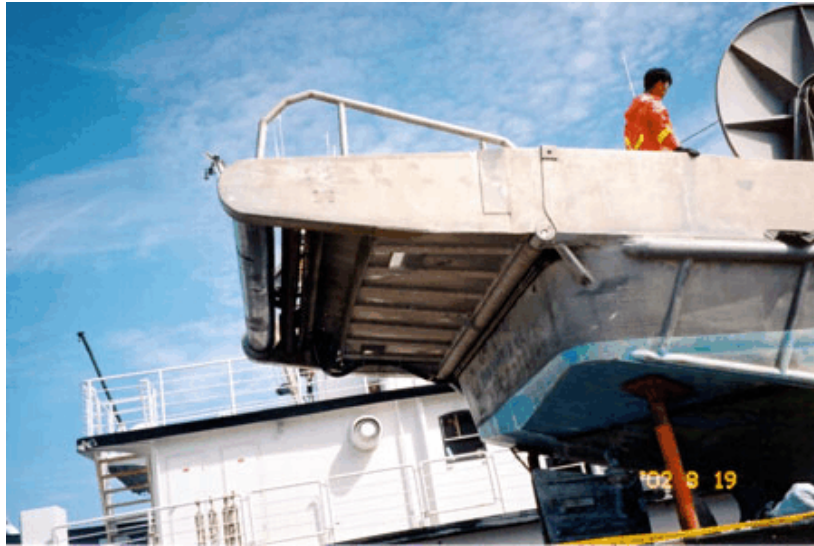
Photo 7. Poupe du Cap Rouge II , avec la robuste rampe se prolongeant au-delà du tableau arrière. Le 19 août 2002
