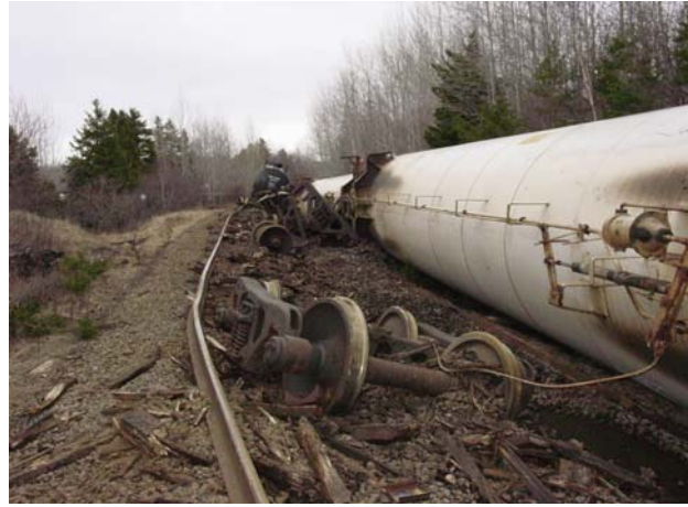
Photo 2. Wagens-citernes de gaz de pétrole liquéfié renversés sur le côté. Noter l'étendue de la destruction de la voie ferrée
