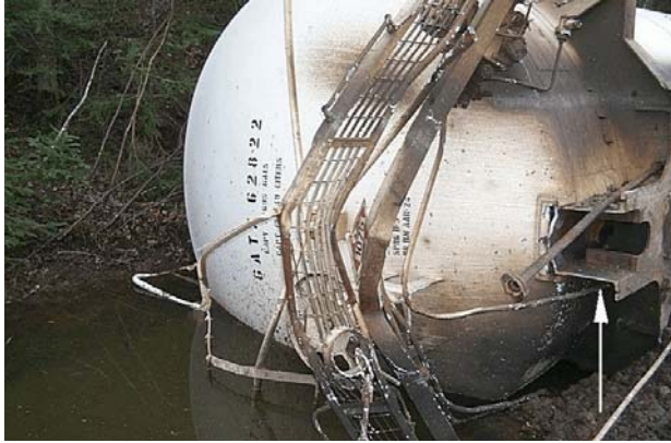
Photo 5. La flèche montre l'emplacement de la longrine tronquée brisée à l'arrière (bout B) du cinquième wagon déraillé, soit le wagon-citerne de gaz de pétrole liquéfié GATX 62822
