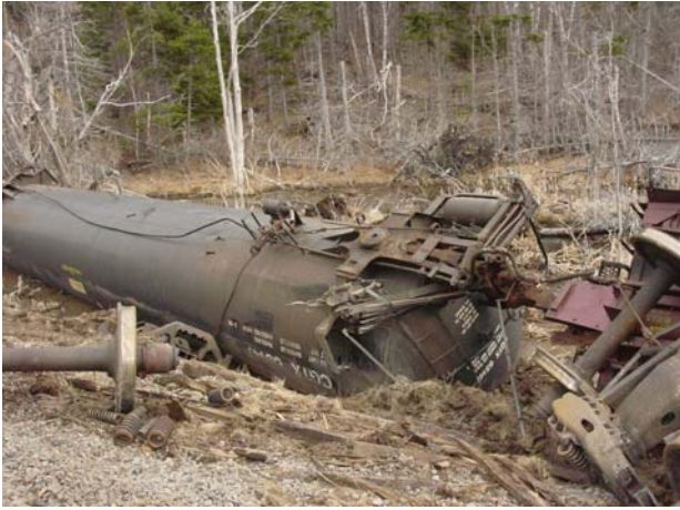
Photo 1. Le premier wagon-citerne de gaz de pétrole liquéfié déraillé, renversé complètement à l'extérieur de l'emprise
