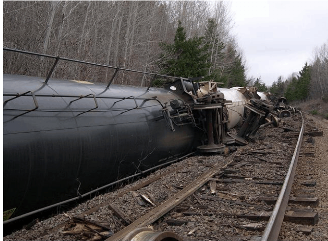
Photo 7. Vue des traverses et des rails près de l'endroit où le déraillement initial s'est produit
