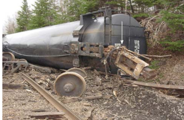
Photo 6. Longrine tronquée rompue du wagon GATX 62822 encore reliée à l'avant (bout A) du sixième wagon déraillé, soit le wagon-citerne de gaz de pétrole liquéfié GATX 2506
