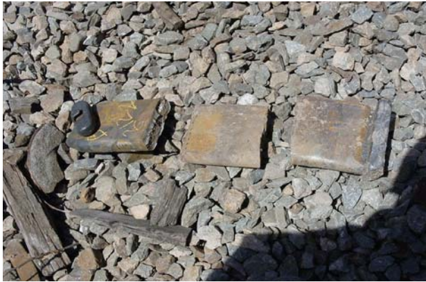
Photo 3. Clavette d'attelage rompue à l'avant (bout B) du troisième wagon déraillé, soit le wagon-citerne de gaz de pétrole liquéfié GATX 2122
