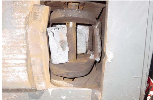
Photo 4. Bras d'attelage rompu à l'avant (bout B) du quatrième wagon déraillé, soit le wagon-citerne de gaz de pétrole liquéfié GATX 9138
