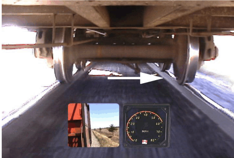
Photo 2. Image de l'essai en marche montrant le soulèvement d'une roue à 60 mi/h
