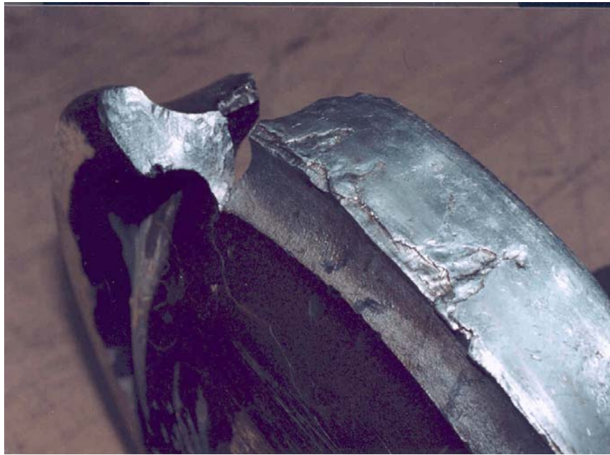
Photo 2. Écaillage de la table de roulement
