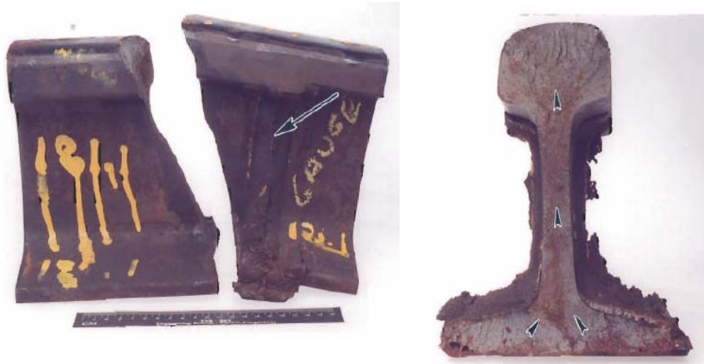
Photo 1. Rail brisé provenant du point milliaire 121,10. Dans l'image de gauche, la flèche montre l'emplacement de la soudure aluminothermique. Les flèches de l'image de droite montrent la progression de la fracture en pointe.
