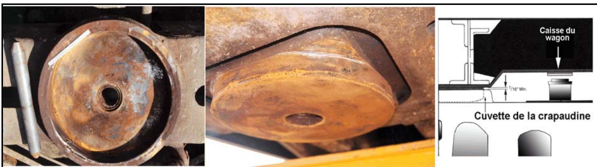
Photo 2. Le bord de la traverse danseuse du wagon FURX 818699 était usé à quatre endroits. L'usure aux angles de la crapaudine correspondait à celle du bord de la traverse danseuse. Le croquis indique les espaces de dégagement entre les deux pièces.
