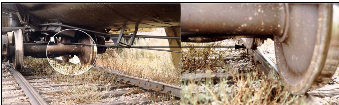
Photo 1. Le bout B du wagon GATX 48058 est resté sur le rail sud incliné. Un gros plan de la zone ombrée montre l'arrachement des crampons qu'on a observé sous le bogie du bout B.
