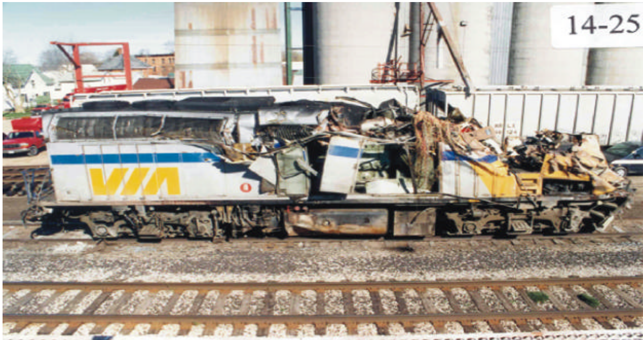
Figure 4 - La locomotive vue de la droite après qu'on l'a redressée. Les dommages sont plus considérables à l'avant droit et le long du côté droit de la locomotive.
