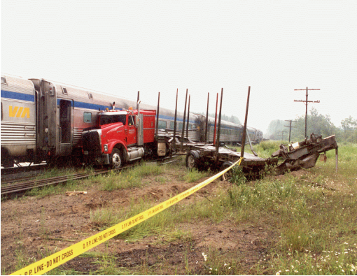
Figure 1 — Position finale du camion et dommages causés à la remorque
