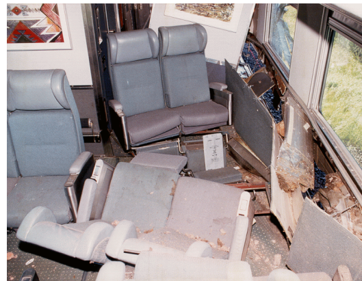
Figure 4 — Dommages causés à l'intérieur par le même impact
