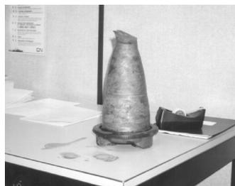
Figure 9 - Vue de la plaque de blocage et de la partie restante du bout de l'essieu
