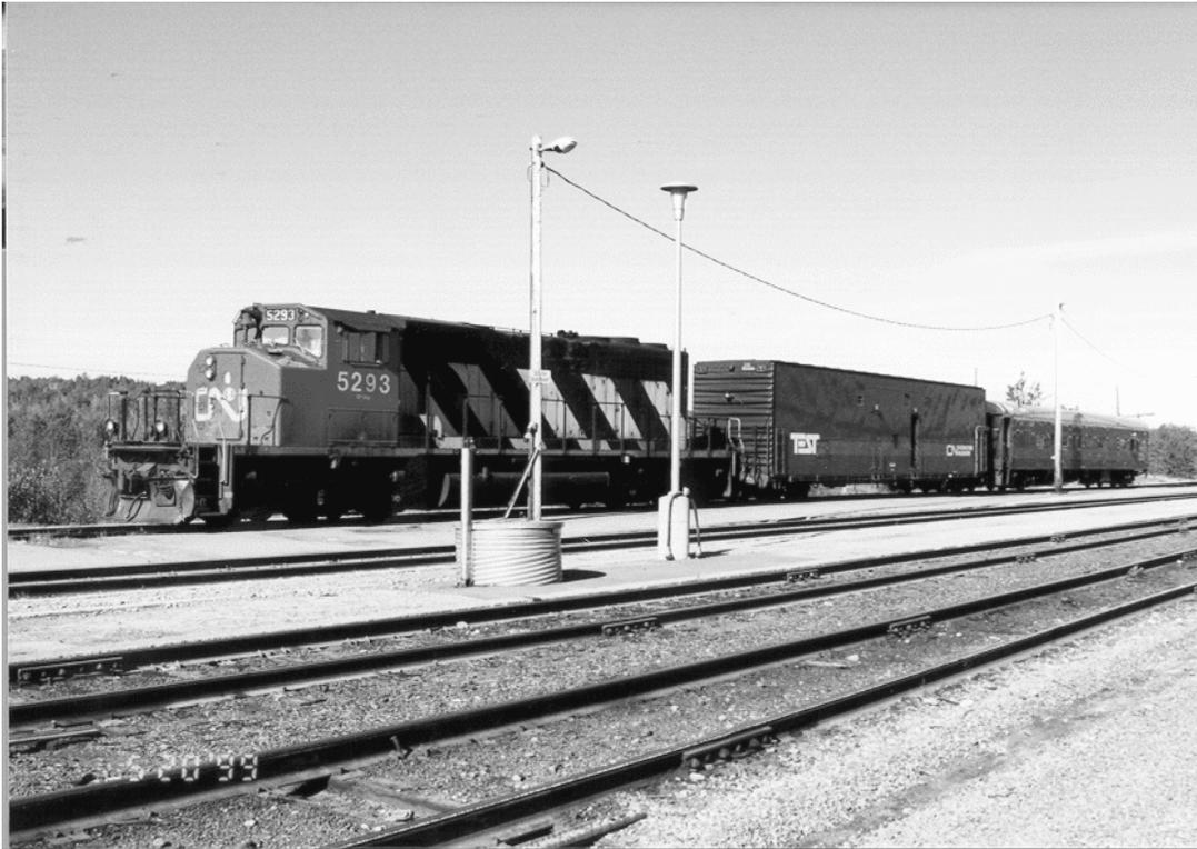
Figure 20 - Configuration type d'un train TEST du CN, locomotive du service marchandises, wagon couvert bourré d'instruments et voiture spécialisée de contrôle de l'état géométrique de la voie
