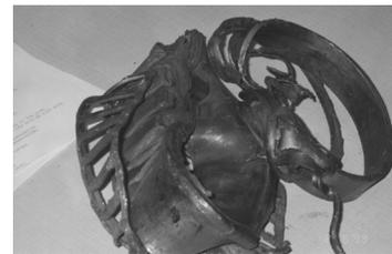
Figure 10 - Morceaux des pièces internes d'un roulement à rouleaux
