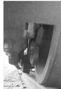
Figure 17 - Vue en bout du boîtier des roulements à rouleaux d'un autorail
