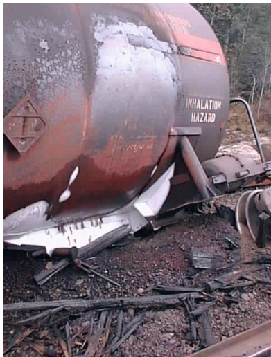
Figure 4 — Partie des dommages causés par le feu au wagon-citerne PROX 81179
