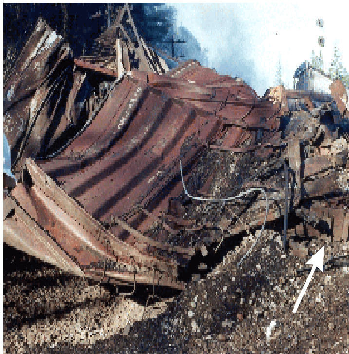
Figure 10 — Dommages causés par l'impact au wagon couvert CN 413849, vue de l'ouest à partir du cratère creusé dans l'emprise. La flèche pointe vers la longrine centrale qui a été tordue à 90 degrés vers le nord.
