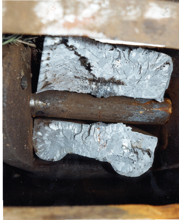
Figure 9 — Bras d'attelage rompu du wagon GATX 9425, indiquant que des forces longitudinales considérables se sont exercées dans le train pendant le déraillement
