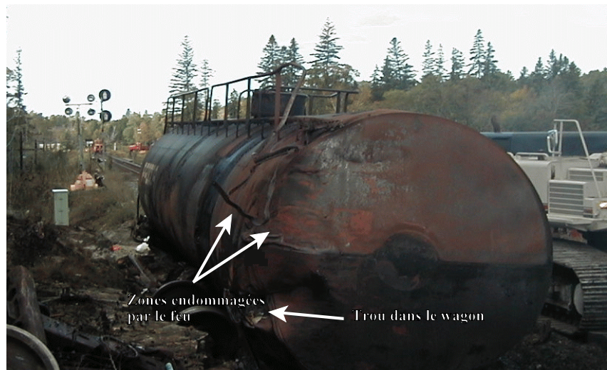
Figure 5 — Dommages causés par le feu et trou au bout « A » (bout sans frein à main) du wagon PROX 81179
