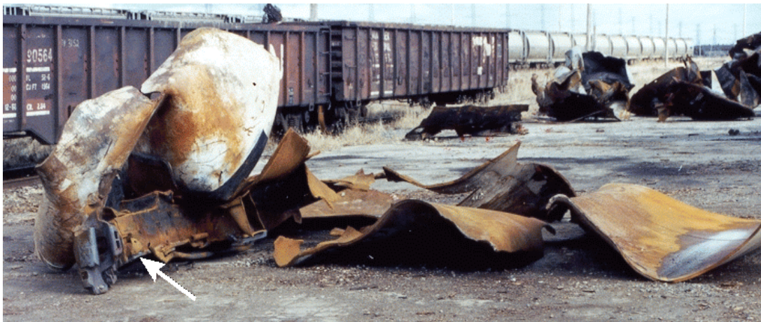
Figure 11 — Partie principale du bout « B » du wagon, y compris la tête et un bout d'environ 16,5 pieds des sections aplaties de la paroi de la citerne qui ont été récupérées après le déraillement. (L'attelage et la longrine tronquée sont à l'avant-plan, en bas à gauche). On peut voir le reste des morceaux du wagon-citerne et de l'enveloppe à l'avant-plan, à droite.
