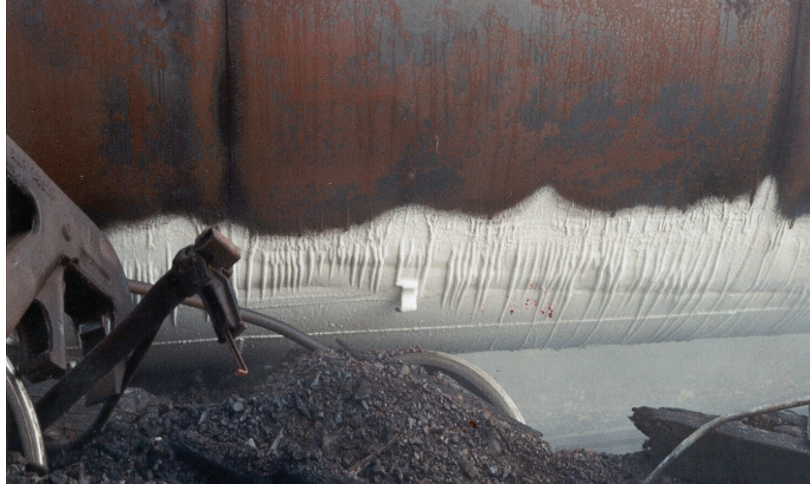
Figure 6 — En raison de la conductibilité thermique, le givrage monte plus haut que la ligne de 10 pouces correspondant au produit réfrigéré qui restait dans le wagon PROX 81179
