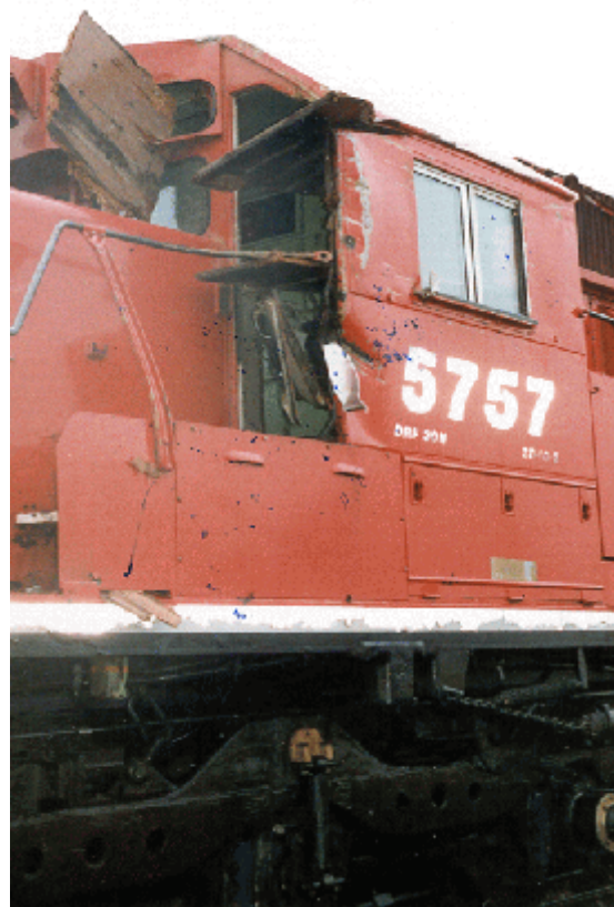
Figure 3 - Dommages à la troisième locomotive du train 472
