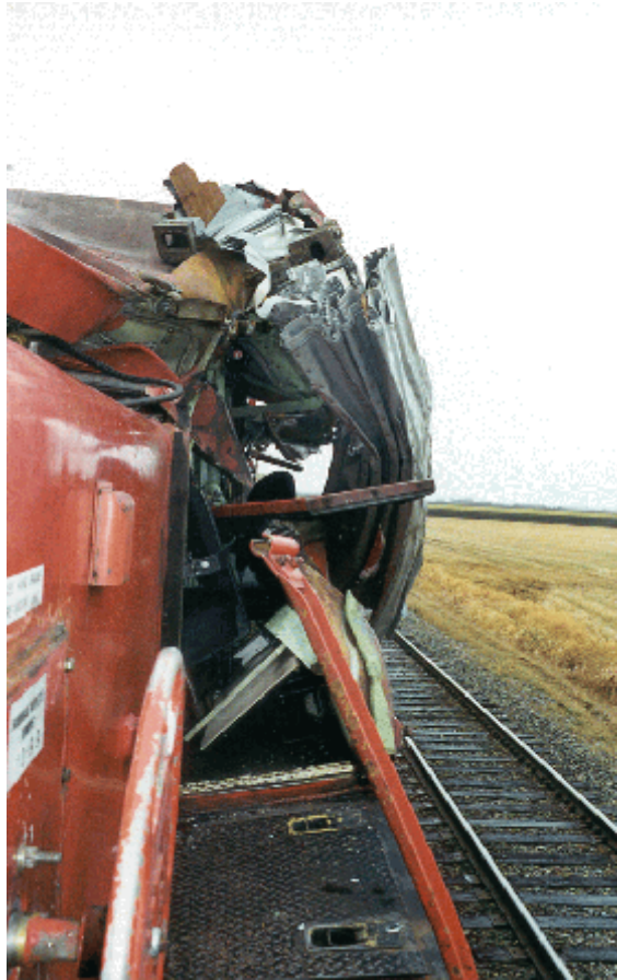
Figure 1 - Dommages à la locomotive de tête du train 472
