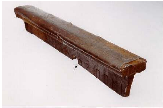
Photo 2. Trou de boulon d'éclisse et rupture de l'âme
