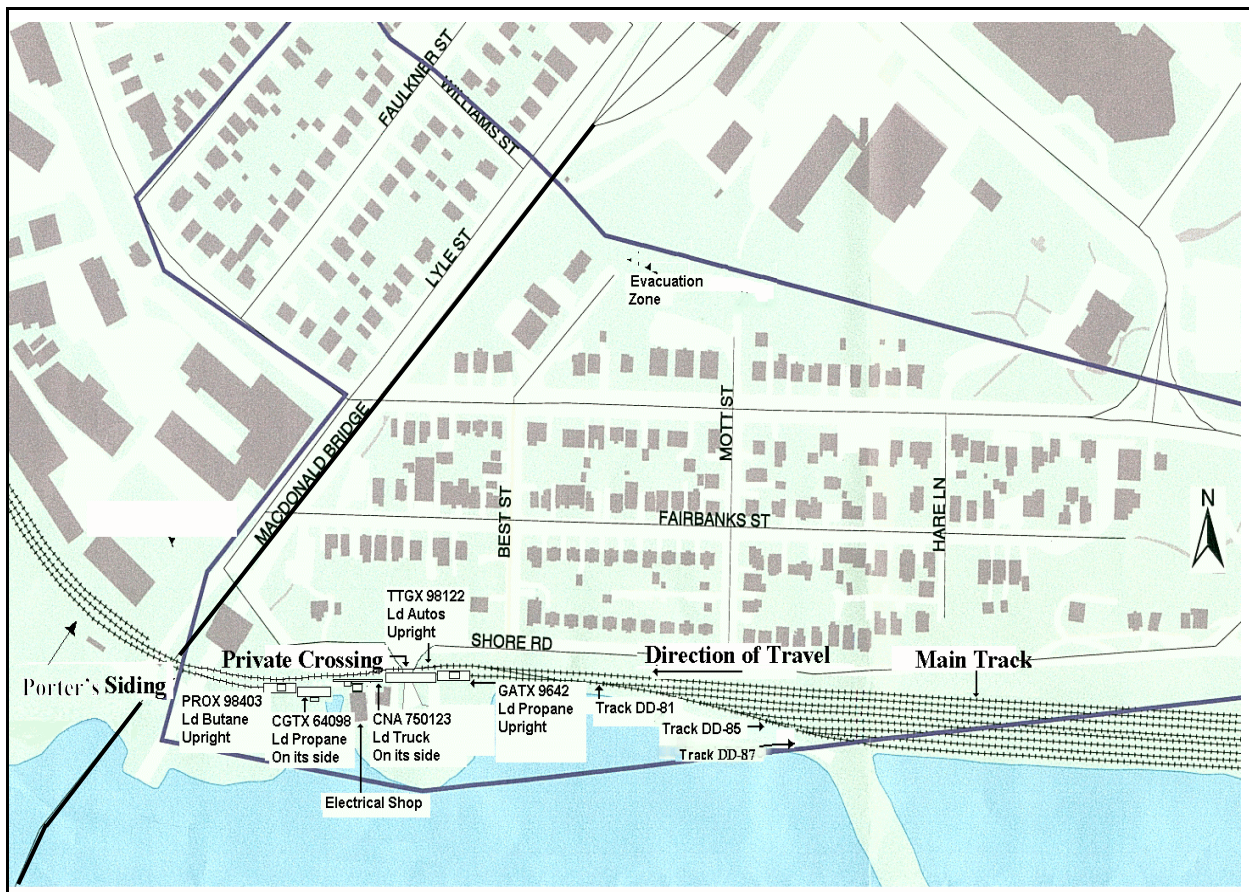
Figure 2. Schéma représentant la zone du déraillement, y compris la voie d'évitement Porter, les wagons déraillés, l'atelier d'électricité, le passage à niveau privé et la zone affectée par l'évacuation. Noter le pont Angus L. MacDonald dans le coin inférieur gauche.
