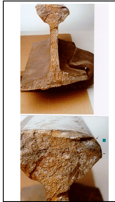
Figure 3 - Défaut transversal affectant 3 % de la surface de rupture du rail.
