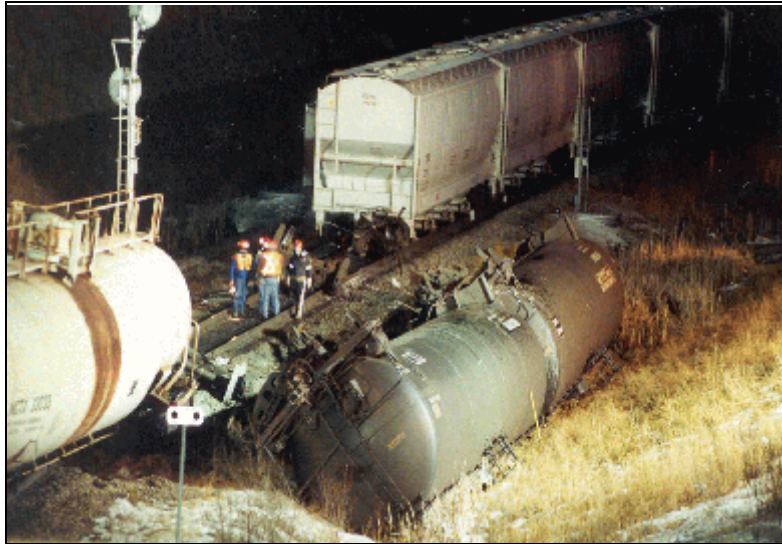
Figure 2 - Wagon-citernes déraillés et renversés dans le fossé
