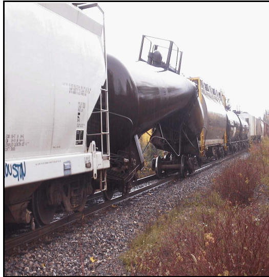
Photo 2. Wagon-citerne CHAX 225 endommagé
