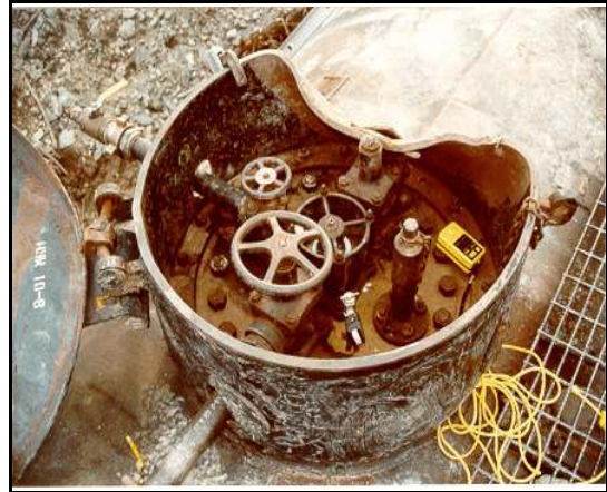
Photo 3. Dommages observés sur les raccords supérieurs du wagon CITX 4240
