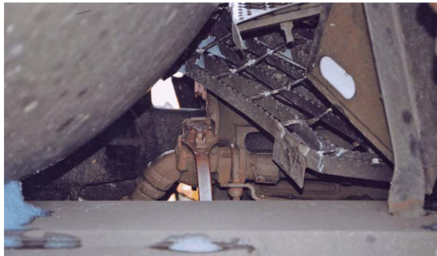
Photo 2. Robinet d'arrêt fermé du wagon couvert CN 557596
