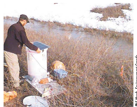
Un chercheur mesure l'écoulement fluvial au moyen de techniques d'injection de colorant.
