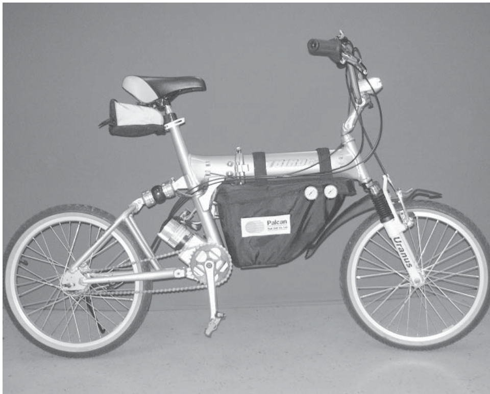
La bicyclette à piles à combustible de Palcan utilise le module d'alimentation PalPac MD
