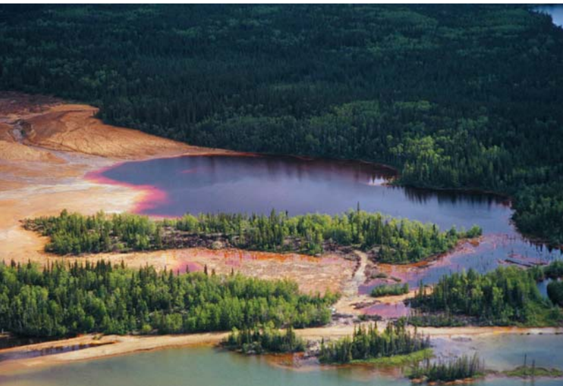
Eau d'égouttement de piètre qualité émanant de la mine de Sherridon située dans le nord du Manitoba. À cet endroit, les déchets et les chantiers se sont oxydés pendant plus de 70 ans, ce qui a provoqué le rejet de concentrations élevées de produits d'oxydation des sulfures dans les eaux de surface. La qualité de l'eau est fortement dégradée dans quatre lacs entourant la mine. En l'absence d'un programme de biorestauration efficace, de l'eau de piètre qualité continuera de s'égoutter pendant des siècles. Le volume d'eau altérée correspond à bien des fois le volume d'eau initial employé pendant l'exploitation minière, ce qui indique qu'on doit inclure les taux d'utilisation pendant les étapes d'exploitation active et d'inactivité dans les vérifications des taux de consommation de l'industrie minière.
