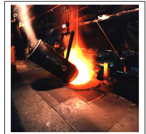
De la ferraille préchauffée qui est chargée dans le four de fusion.
