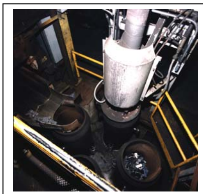
Le système de préchauffage de ferraille en position de chargement (à l'extrême gauche); En position de préchauffage (en haut); la benne avec la ferraille préchauffée prête à être envoyée au four à fusion (à droite).
