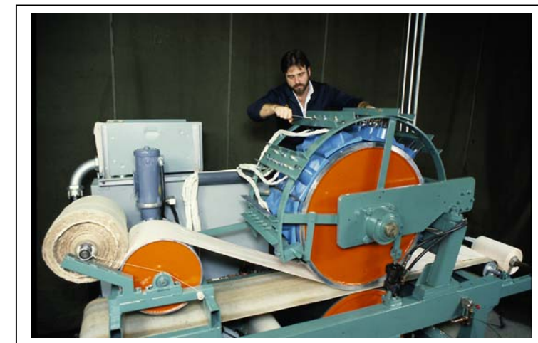
Prototype préliminaire d'une presse avec rouleau chauffé par induction
