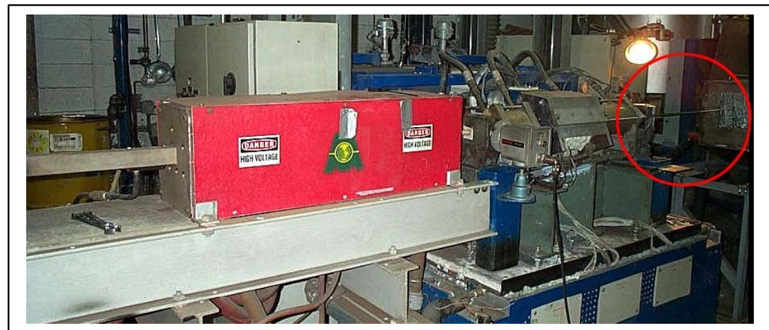
Chambre de préchauffage (en rouge) et de revêtement (en bleu) du fil
