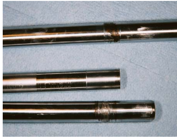
Photo 1. Tube d'injection de carburant
