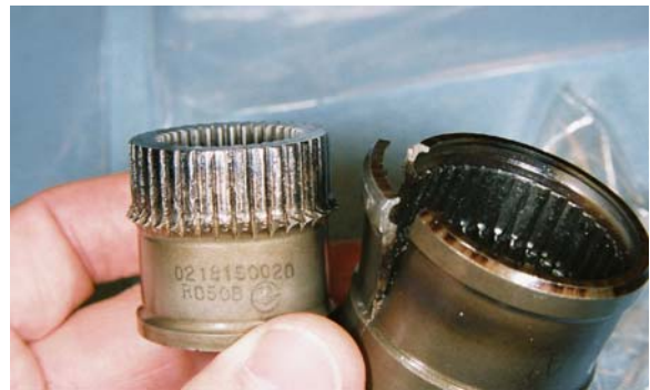
Photo 2. Cannelures d'entraînement foirées sur le nez d'arbre et le manchon d'accouplement avant
