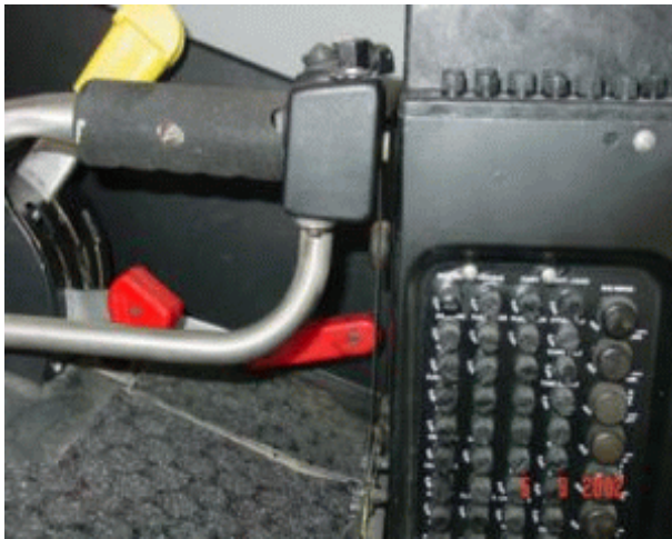
Figure 1. Espace de 5 mm pour la lame de verrou
