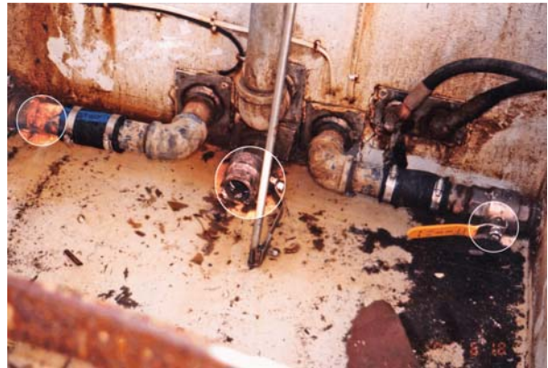
Photo 5. Vue dans la cambuse montrant les soupapes de vidange des viviers et de la cambuse.
