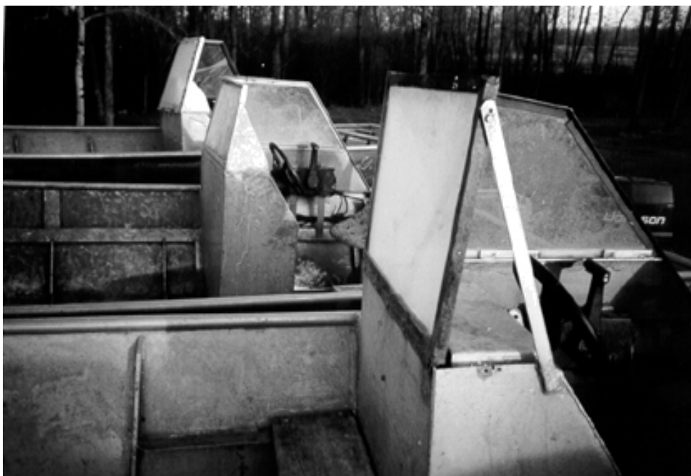
Aménagement typique du poste de commande du moteur
