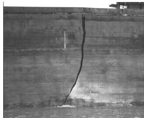
Photo 3. Fracture du côté bâbord
