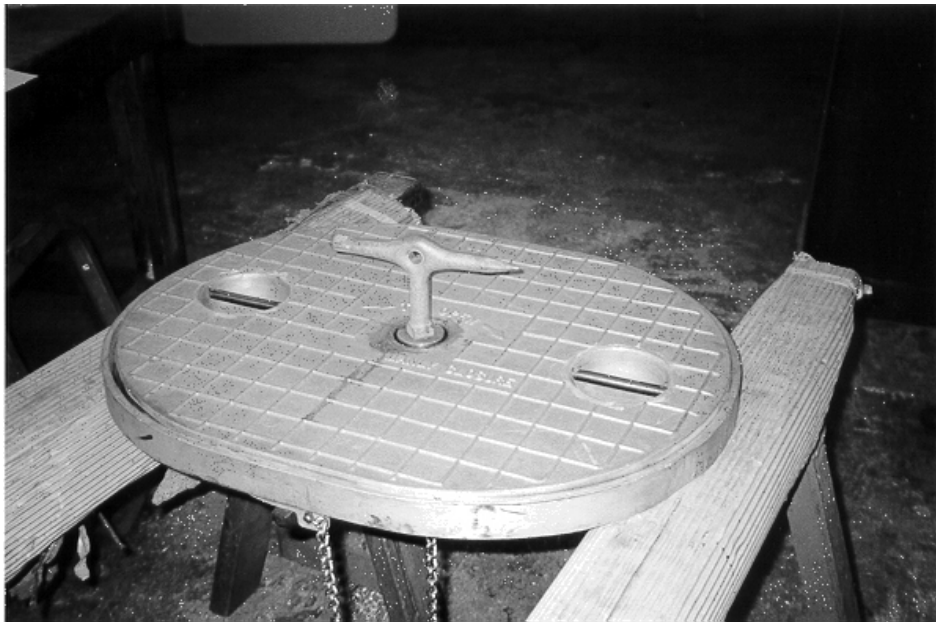
Nouveau couvercle en aluminium encastré conçu par la Manly Marine Closures, Ltd., identique à celui qui s'est délogé. À noter le boulon de verrouillage encastré avec sa goupille de blocage en place.
