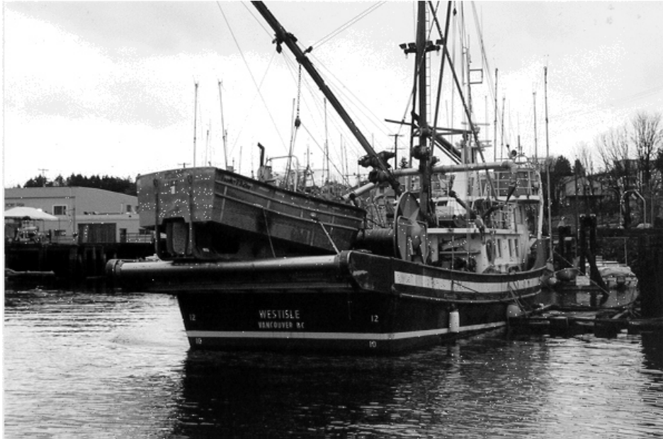
Le "WESTISLE" amarré aux installations d'Alberni Engineering de Port Alberni (Colombie-Britannique) le 3 mars 1999. Noter que l'arrière du bateau de travail se trouve à bâbord de l'axe longitudinal, là où il a été placé lors de l'incident.
