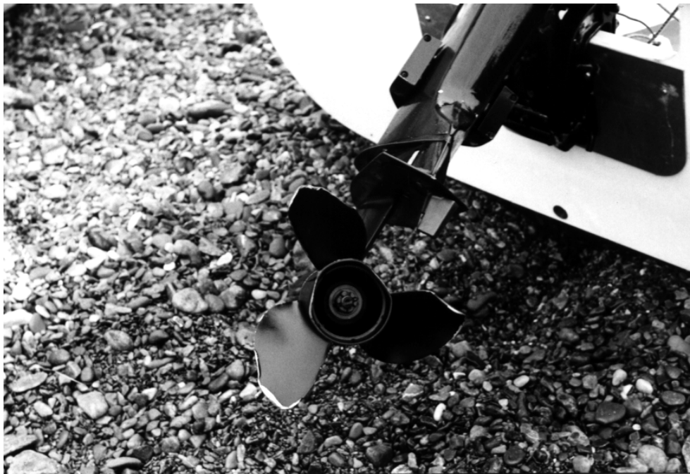
Photo 3. Vue des pales de l'hélice endommagées
